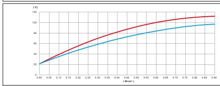
Variation, en fonction de la puissance en W/cm² du ruban chauffant en silicone, de la température de paroi d'un tube en acier inoxydable rempli d'eau non circulante, non isolé thermiquement
