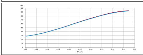
Variation, en fonction de la puissance en W/cm² du ruban chauffant en silicone, de la température de paroi d'un tube en acier galvanisé rempli d'eau non circulante, isolé thermiquement par 20mm de mousse PVC-NBR
