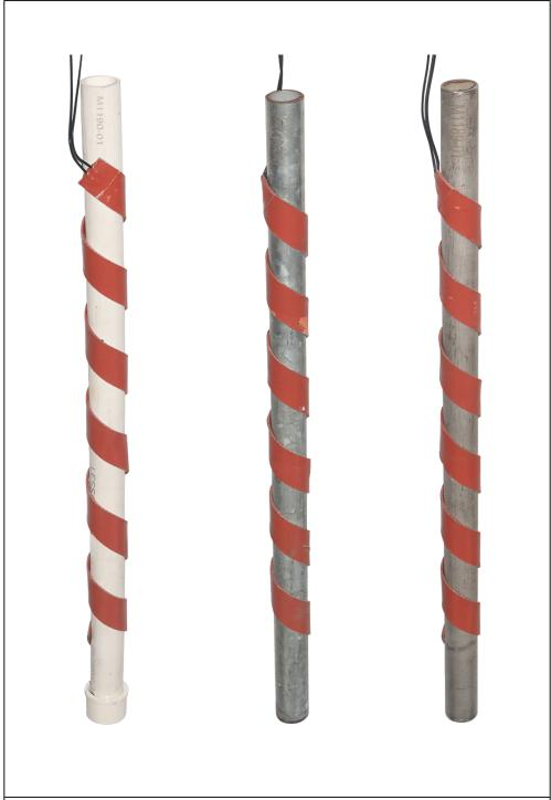
Condition des essais comparatifs : Bandes chauffantes en silicone enroulées sur des tubes de diamètre extérieur 25mm en PVC-U, acier galvanisé et acier inoxydable
