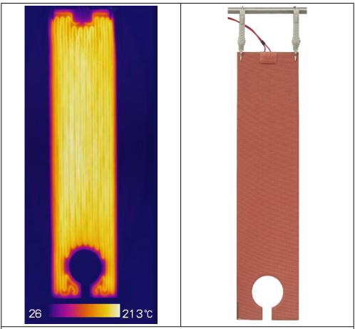
Image thermographique d'un résistance chauffante plate silicone épaisseur 2,4 mm chargée à 1W/cm², suspendue dans l'air calme, non fixée sur une paroi, à une température ambiante de 25°C. La température de surface atteint 213°C, soit une valeur proche de la destruction.
