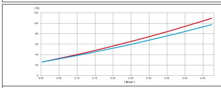
Variation, en fonction de la puissance en W/cm² du ruban chauffant en silicone, de la température de paroi d'un tube en acier inoxydable rempli d'eau non circulante, isolé thermiquement par 20mm de mousse PVC-NBR
