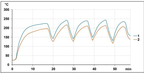
Mesure faites sur une ceinture chauffante de 200mm montée sur un fût de 55 Gallons (200 litres). Puissance 2250W (0.75W/cm²), régulateur PID avec capteur situé au centre du réservoir vide. Température de surface limitée à 190°C par un thermostat à disque.
