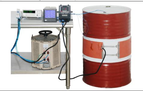
Variation de la température dans le temps de la température d'un fût métallique de 220 litres, rempli d'eau, réchauffé par une ceinture chauffante silicone de largeur 200mm, sans isolation thermique, de puissance 1500W (charge surfacique 0.5W/cm²).
