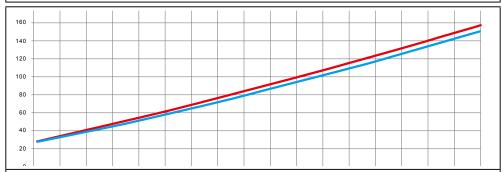
Variation, en fonction de la puissance en W/cm² du ruban chauffant en silicone, de la température de paroi d'un tube en acier inoxydable vide, isolé thermiquement par 20mm de mousse PVC-NBR
