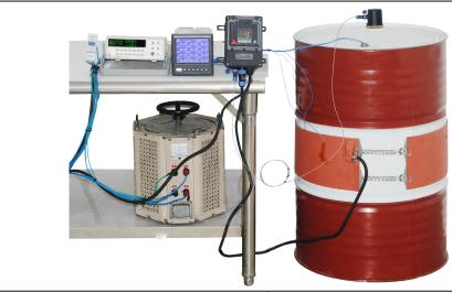
Variation de la température dans le temps de la température d'un fût métallique de 220 litres, rempli d'eau, réchauffé par une ceinture chauffante silicone de largeur 200mm, sans isolation thermique, de puissance 2250W (charge surfacique 0.75W/cm²).
