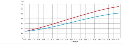
Variation, en fonction de la puissance en W/cm² du ruban chauffant en silicone, de la température de paroi d'un tube en PVC rempli d'eau non circulante, isolé thermiquement par 20mm de mousse PVC-NBR
