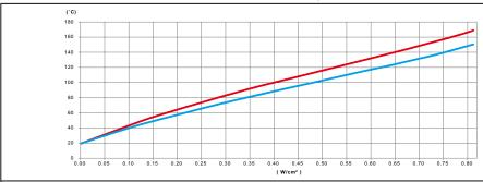
Variation, en fonction de la puissance en W/cm² du ruban chauffant en silicone, de la température de paroi d'un tube en acier inoxydable vide, non isolé thermiquement
