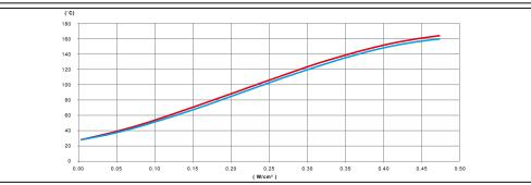
Variation, en fonction de la puissance en W/cm² du ruban chauffant en silicone, de la température de paroi d'un tube en acier galvanisé vide, isolé thermiquement par 20mm de mousse PVC-NBR
