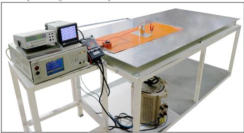
Dispositif d'essai de mesure du courant de fuite à chaud
