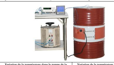
Variation de la température dans le temps de la température d'un fût métallique de 220 litres, rempli d'eau, réchauffé par une ceinture chauffante silicone de largeur 200mm, sans isolation thermique, de puissance 2250W (charge surfacique 0.75W/cm²).
