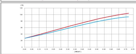
Variation, en fonction de la puissance en W/cm² du ruban chauffant en silicone, de la température de paroi d'un tube en acier galvanisé rempli d'eau non circulante, non isolé thermiquement
