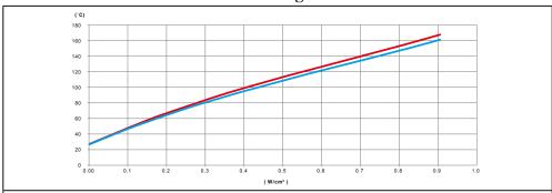
Variation, en fonction de la puissance en W/cm² du ruban chauffant en silicone, de la température de paroi d'un tube en acier galvanisé vide, non isolé thermiquement
