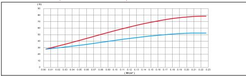
Variation, en fonction de la puissance en W/cm² du ruban chauffant en silicone, de la température de paroi d'un tube en PVC vide, non isolé thermiquement
