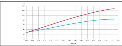
Variation, en fonction de la puissance en W/cm² du ruban chauffant en silicone, de la température de paroi d'un tube en PVC rempli d'eau non circulante, non isolé thermiquement
